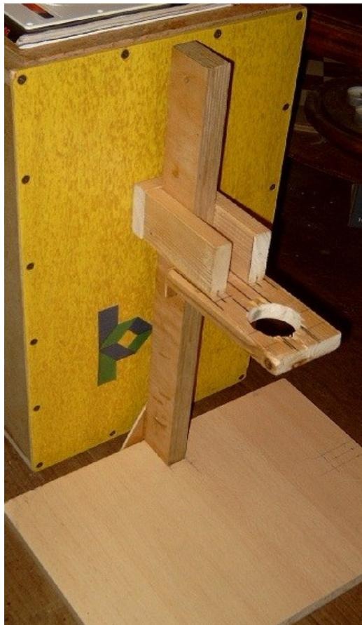
Am praktikabelsten hat sich herausgestellt, dass, wenn man die beiden Backen des Schlittens von hinten packt und so die eingespannte Maschine auf und ab bewegt, die Ergebnisse der gebohrten Löcher am besten sind.
