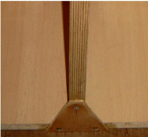
Schon steht die Säule auf der Bodenplatte fest und in alle Richtungen vor kippen sicher.
